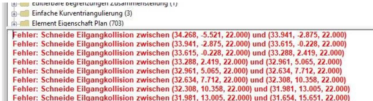
Die Meldungen werden auch angezeigt, wenn bei der Simulation mit >> direkt an das Ende gesprungen wird.
