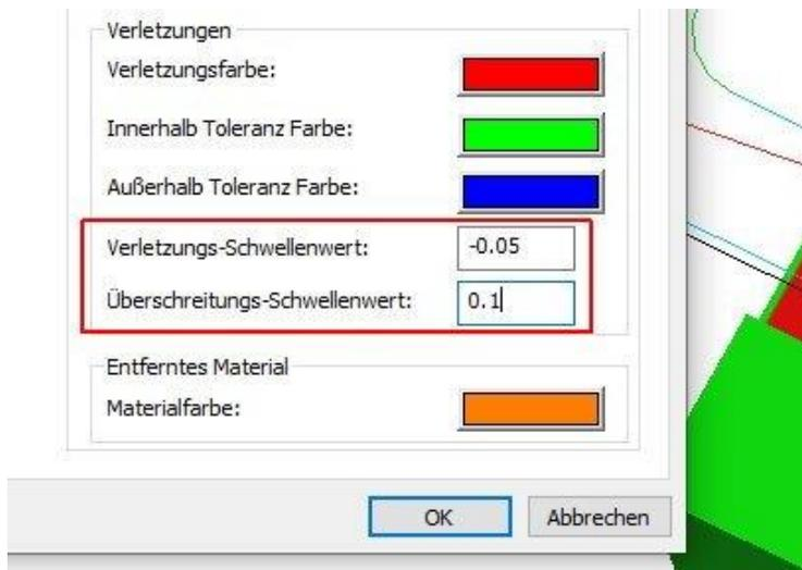
Um Verletzungen anzuzeigen, muss zum Start der Simulation neben dem Bearbeitungsmodell und den Werkzeugwegen auch der Ordner mit den triangulierten Flächen selektiert werden. Zudem muss in der Simulation die Option **Darstellung > Verletzungsfarben** aktiviert sein..
