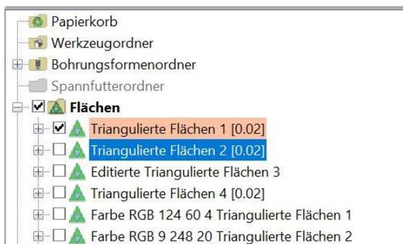
**9492: Benutzeroberfläche:** Die RGB-Werte der Flächenfarben in der Statusleiste werden jetzt auch für Flächen aus RAW-Dateien angezeigt. Zur Anzeige der RGB-Werte muss unter **Optionen > Präferenzen** die Option **Anzeige der RGB-Werte in der Statusleiste** aktiv sein.
