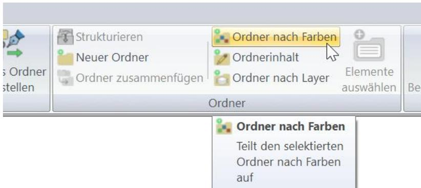
**9272: Import: Kurven mit Farben.** In NCG CAM können unterschiedliche Farben für die Linear- und Kreissegmente von Kurven festgelegt werden. Beim Import von Geometriedateien (STEP, IGES usw.) werden nun beide Farben gleichgesetzt, auch wenn eine Kurve ausschließlich Linear- oder Kreissegmente aufweist. Diese Anpassung wurde notwendig, um die oben beschriebene Option **Ordner nach Farben** auf Kurven anwenden zu können. Diese Option funktioniert nur, wenn Kurven eine Farbe haben.
