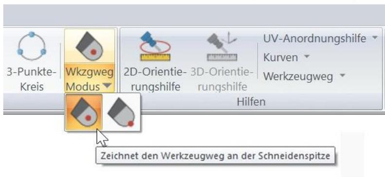
**9269: Benutzeroberfläche:** Die Symbole im Ribbon-Menü zur Darstellung des Werkzeugwegs im Mittelpunkt oder an der Spitze wurden für das Drehen aktualisiert, und zeigen nun ein Drehwerkzeug anstelle eines Fräswerkzeugs.
