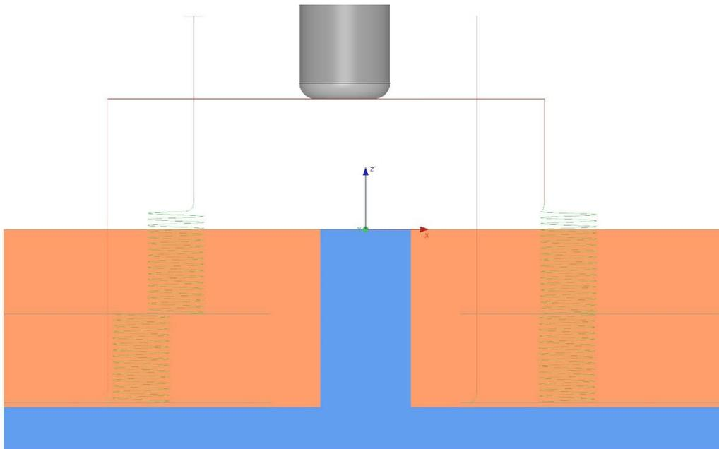
Mit Version 19.0.05 wird der Sicherheitsabstand nicht mehr auf die Oberseite des Bauteils angewandt. Das heißt, durch herabsetzen der Sicherheitsebene kann die Höhe der Positionierbewegung über dem Bauteil reduziert werden. Im Bild unten wurde die Sicherheitsebene auf 3mm gesetzt und der Fräser positioniert auf dieser Höhe.
