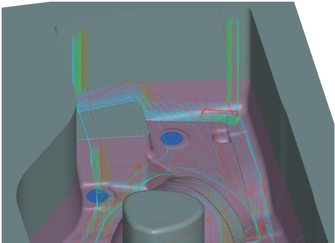
**9743: Verketten:** Beim Verketten von axial vervielfachten horizontalen Bahnen musste der Anwender bisher selbst sicherstellen, dass die Helix-Eintauchbewegung zwischen den Ebenen hoch genug beginnt. Jetzt wird die Höhe der Helix-Eintauchbewegung automatisch auf die korrekte Höhe entsprechend der Zustellung beim axialen Vervielfachen eingestellt.
