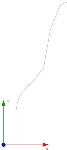
Die erzeugte Kurve kann beispielsweise zum Abdrehen eines Halters verwendet werden, um diesen genau an die Form des Bauteils anzupassen.
