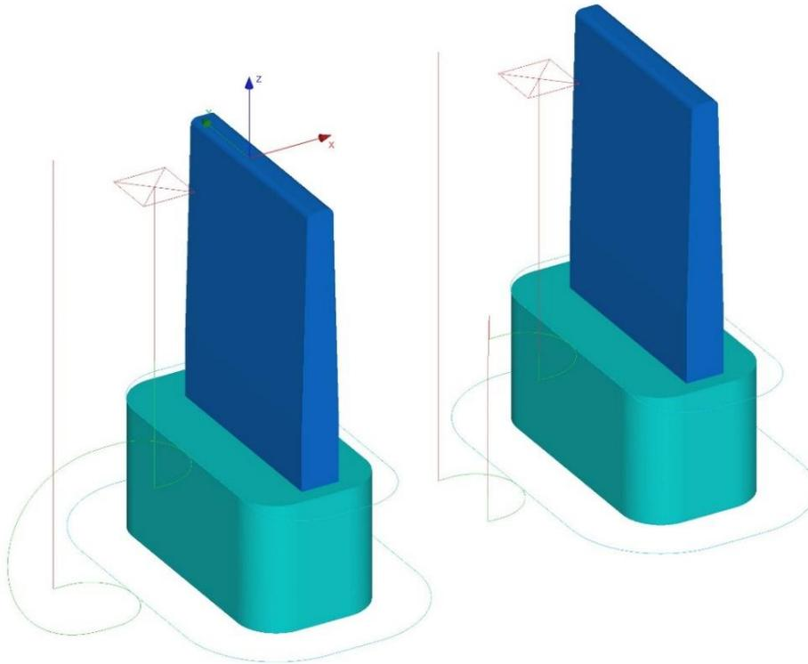
Auf der linken Seite wird mit einer weichen Zustellung von einer Bahn zur anderen gefahren, während auf der rechten Seite eine Eilgangbewegung verwendet wird. Wenn die Bahnen, wie im Bild oben gezeigt, weit auseinander liegen, kann es vorteilhaft sein, eine Eilgangbewegung zu wählen. Bei enger beieinander liegenden Bahnen ist eine weiche Verbindung oft besser. Die neue Option ermöglicht jetzt die Auswahl zwischen diesen beiden Ansätzen.
