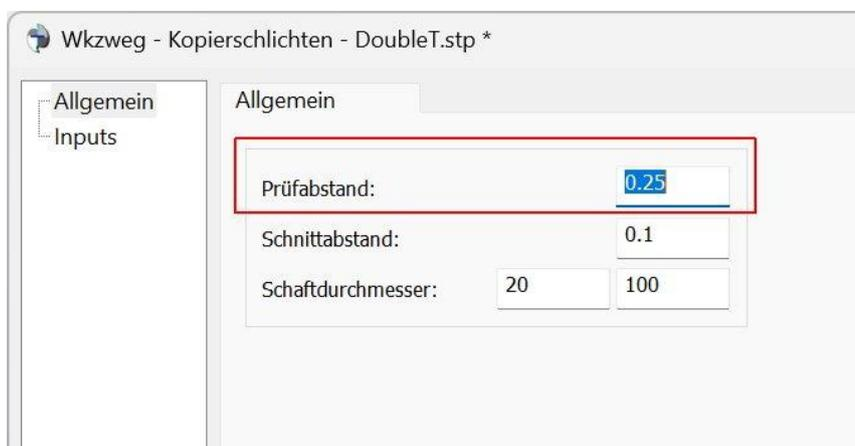
**8422: Kopierschlichtbahnen:** Das Trimmen der Bahnen über einen Kontaktwinkel auf vertikalen Flächen wurde verbessert. Zuvor wurden teilweise Bereiche ausgelassen.
