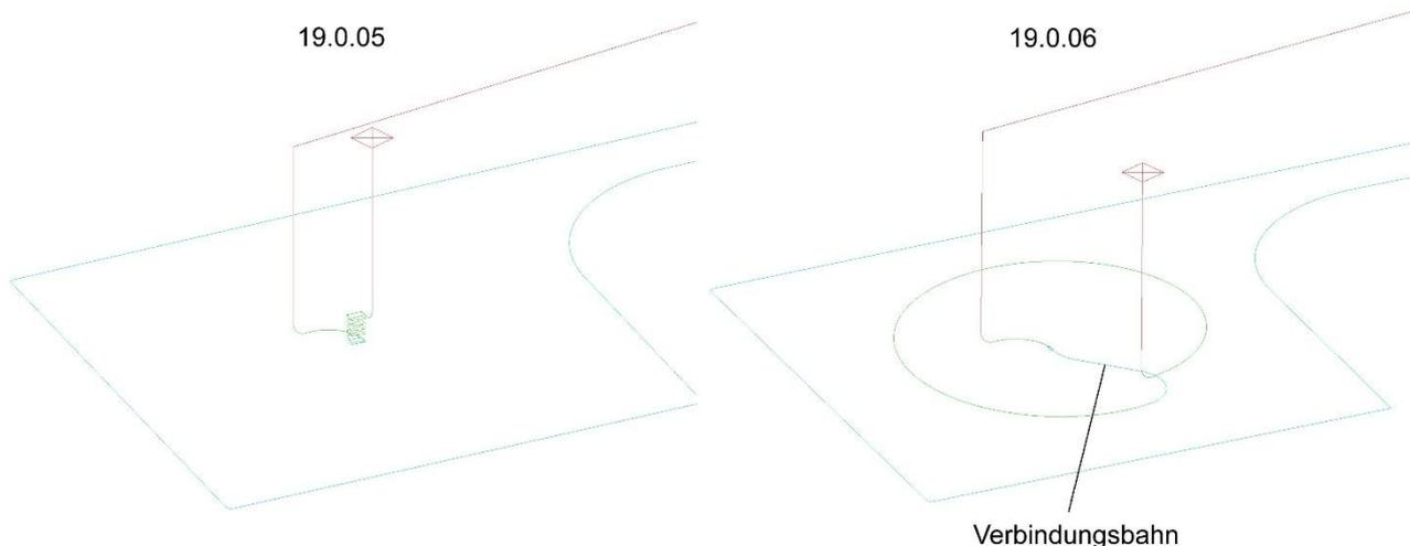
**9457: Verketteten:** Beim Verketteten von Ebenen-, Kern- und Zickzack-Schruppbahnen wird zur Sicherheit der **Vorschubabstand** auf 2 gesetzt, wenn die **vertikalen Einfahrradien** auf 0 gesetzt werden.
