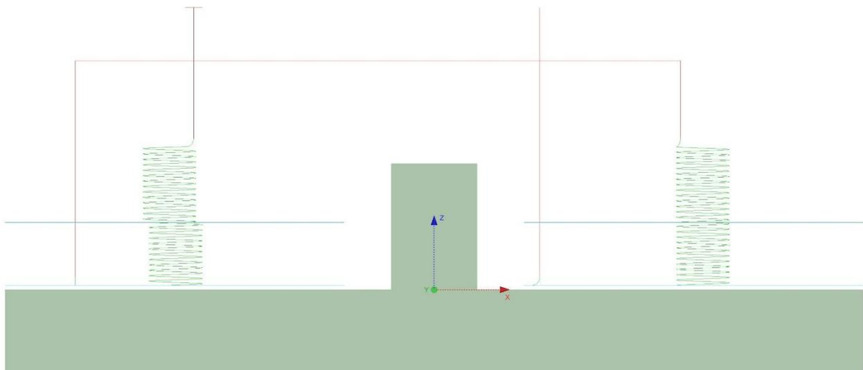
Die Positionierungsbewegung im Eilgang von einer Seite zur anderen erfolgt sehr hoch über dem Teil. Dies liegt daran, dass der Wert **Abstand zur Fläche** auch auf der Oberseite des Teils angewendet wird.
