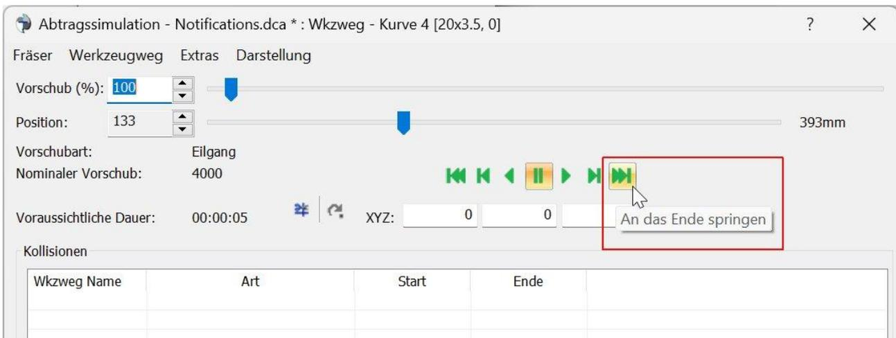
Wird eine Kollision orange anstatt rot angezeigt, handelt es sich noch nicht um eine Kollision, sondern es zeigt, dass sich der Halter näher am Material befindet als der gewählte **Sicherheitsabstand**. Dabei handelt es sich um den Sicherheitsabstand, den man bei den Optionen der Simulation bestimmt, und nicht den bei der Bahnberechnung eingegebenen Sicherheitsabstand.
