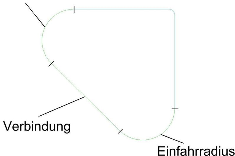
**10110: Verketteten:** Bei einer Bearbeitung mit einem sehr großen XY-Aufmaß (15mm) konnte es vorkommen, dass der Fräser beim Positionieren das Bauteil berührte. Dieses Problem wurde behoben.
