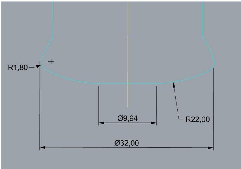
Im Dialog bei **Fräser: Konvexe Schneide** anwählen, und den Fräser definieren. Diese Fräserart steht auch bei den 5-Achsen Strategien zur Verfügung.
