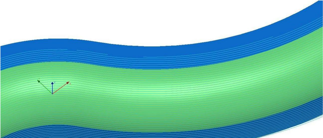
Unten: Bahnen mit v19.0.10, jetzt mit geschlossener Bahn am Rand.
