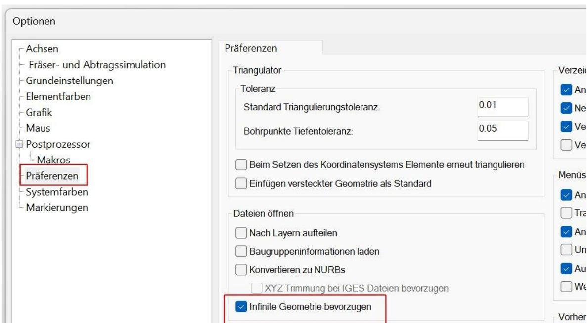
**9093: Import:** Wurde beim Einlesen von STEP Dateien, oder beim Einlesen von IGES Dateien mit der Option **Konvertieren zu Nurbs**, gleichzeitig die Option **Nach Layern aufteilen** aktiviert, wurden die Layer nicht immer korrekt erzeugt. Dies wurde jetzt behoben.
