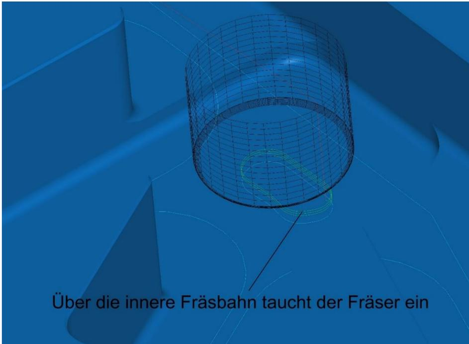
Bei einem Wendeschneidplattenfräser konnte dies dazu führen, dass der Fräser aufsitzt.
