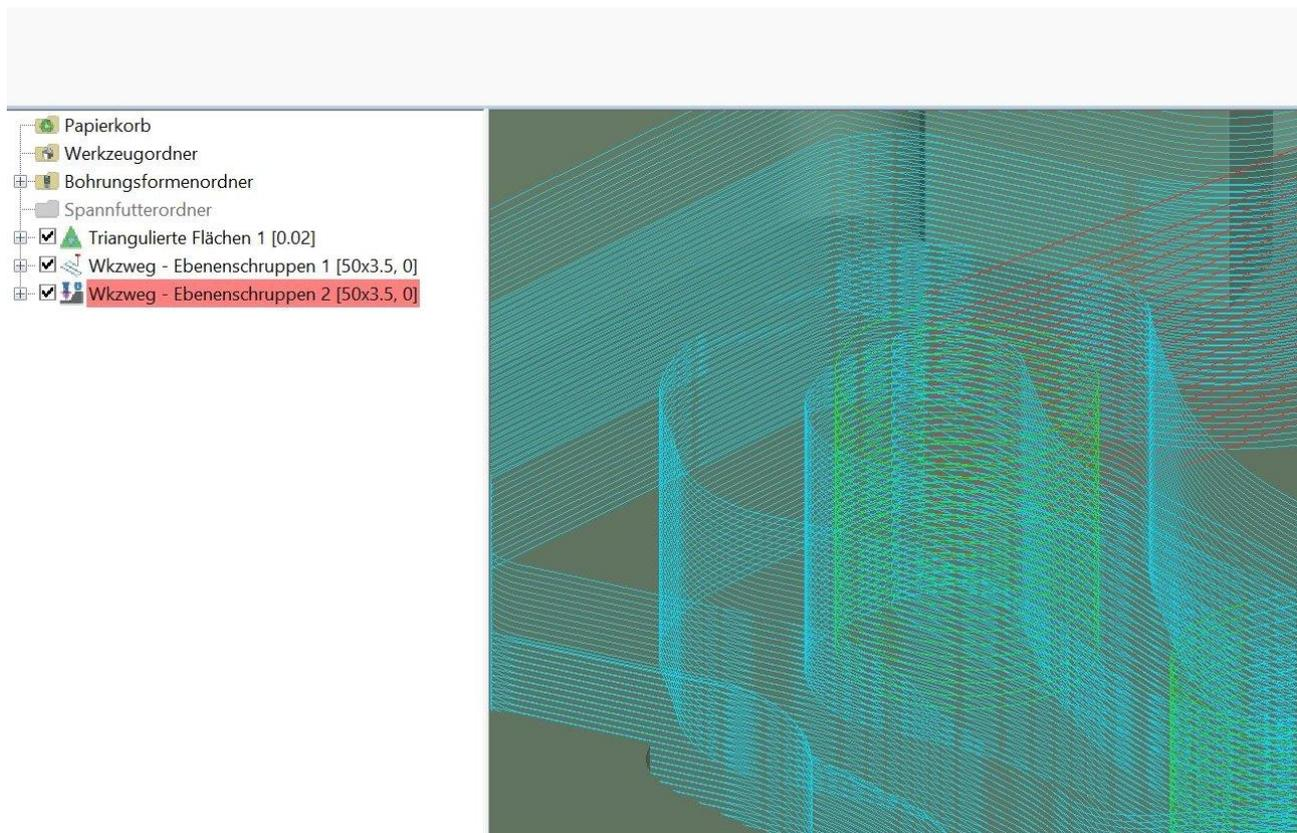
**Warnung:** Die Verwendung des Schaftprofils beim Schruppen kann unsicher sein, da das Schaftprofil nur die Flächen berücksichtigt, und kein zurückbleibendes Restmaterial. Für das Schruppen wird deshalb empfohlen die Bahnen mit einem Halter zu berechnen.
