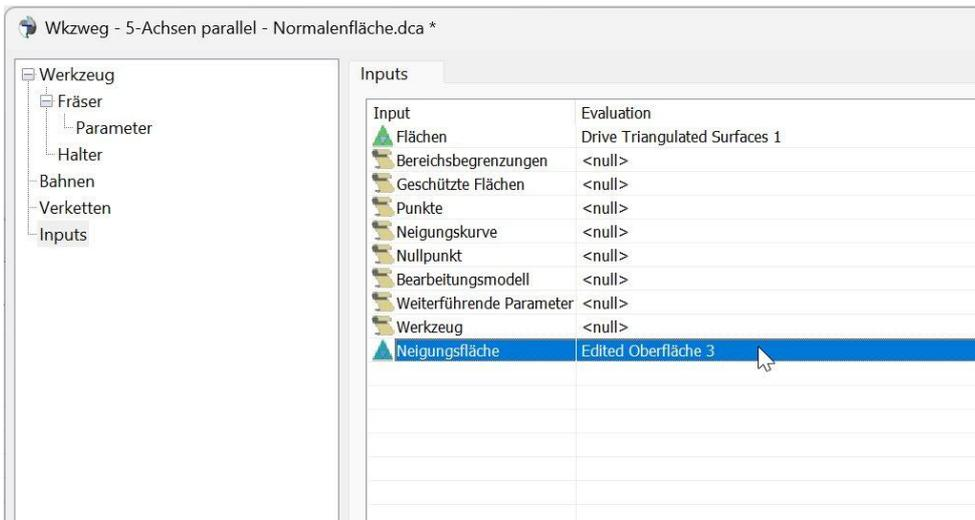
**9465: 5-Achsen:** Eine Reihe Parameter für die Glättung der Werkzeugachse wurden hinzugefügt. Diese sind verfügbar bei der Verwendung von Lollipop- und Kugelfräsern.
