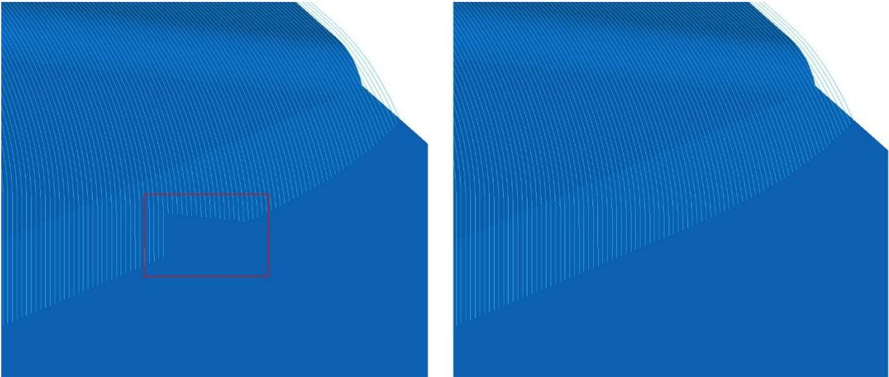
**8891: Z-Konstant Bahnen mit selektierten Flächen:** Es ist jetzt möglich unter **Inputs** die zu bearbeitenden Flächen auszutauschen. Unter **Flächen** müssen alle Flächen angegeben werden. Unter **Geschützte selektierte Flächen**, werden die Flächen angegeben, die nicht bearbeitet werden sollen.
