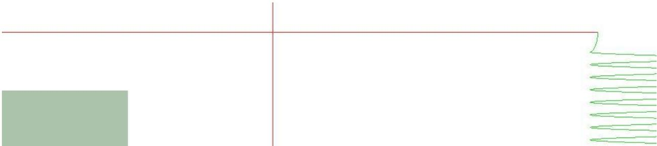
**Achtung:** Wird die **Sicherheitsebene** tiefer als Z Max des Bauteils gesetzt, was man nicht tun sollte, wird das Bauteil nicht verletzt, aber es kann sein, dass der Fräser über den höchsten Punkt kratzt. Das trifft bei allen Strategien zu, nicht nur beim Schruppen.
