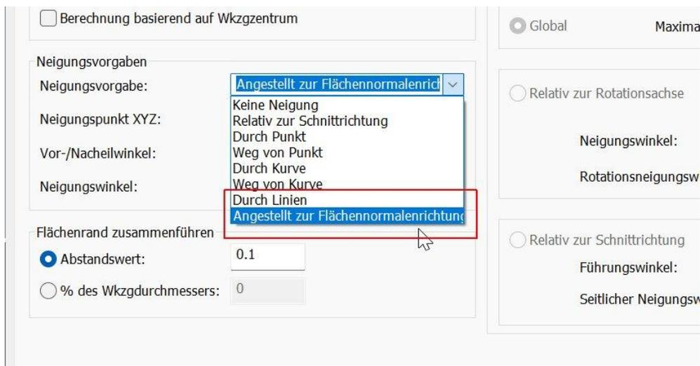
**Bei Angestellt zur Flächennormalenrichtung** wird ein weiterer Flächenordner angewählt, dessen Flächen die Neigung bestimmen. Das Werkzeug stellt sich senkrecht zu diesen Flächen. Im Bild unten wird als Beispiel einfach eine ebene Fläche bearbeitet, und die roten Flächen bestimmen die Richtung der Werkzeugachse.
