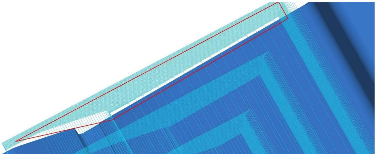
**10028: Adaptives Schrappen:** Bei der Berechnung von adaptiven Schrapp-Werkzeugwegen können jetzt Werkzeuge mit konvexer Schneide, bzw. Hochvorschubfräser eingesetzt werden. Die Fräserart, die unterstützt wird, hat an der Unterseite einen großen Radius, der in einen kleineren Eckenradius übergeht.
