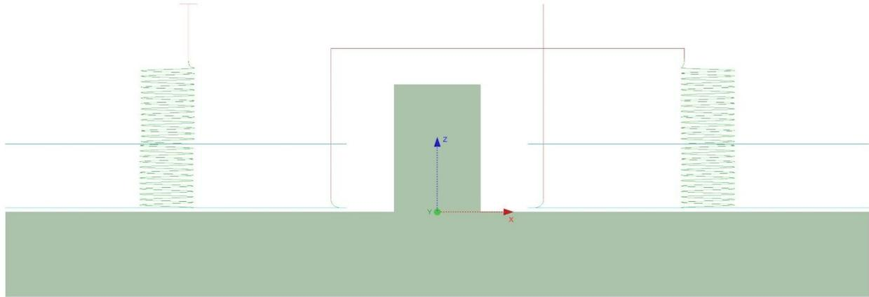
Die Eilgangbewegung über das Bauteil wird mit dem Wert des neuen Parameters **Abstand zu den Schnitten** ausgeführt. In der Grundeinstellung entspricht der Wert der halben Stufentiefe, jedoch nicht kleiner als 1. Dieser Wert kann vom Anwender auf einen niedrigeren Wert geändert werden. Eine Vergrößerung ist bis zum selben Wert von **Abstand zur Fläche** möglich.
